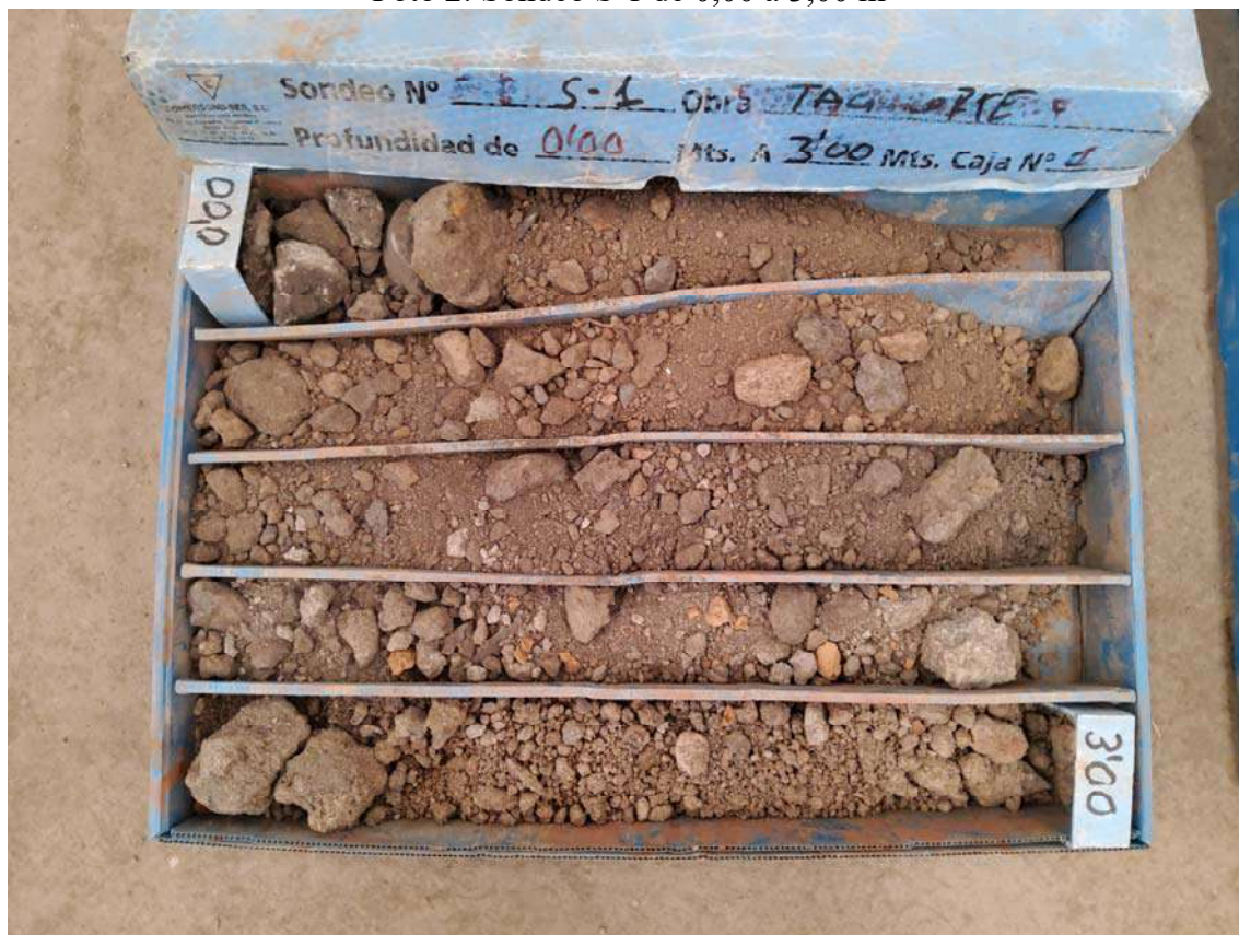
Foto 2: Sondeo S-1 de 0,00 a 3,00 m
