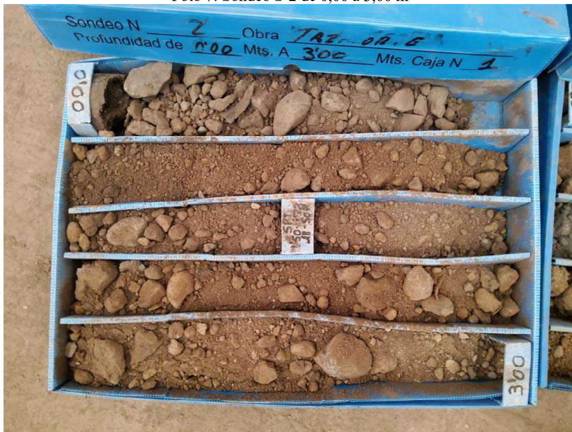
Foto 7: Sondeo S-2 de 0,00 a 3,00 m
