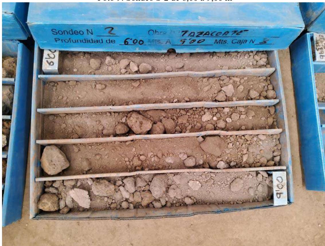
Foto 9: Sondeo S-2 de 6,00 a 9,00 m
