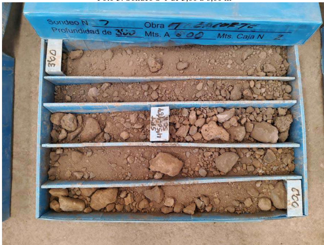
Foto 3: Sondeo S-1 de 3,00 a 6,00 m
