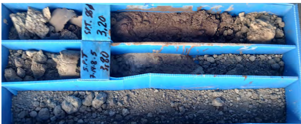
Figura 4.1.2.1: Fotografía del Nivel Ia: picón medio a denso, correspondiente al sondeo 3.
